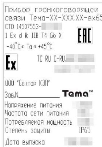
Рисунок 6 – Вид маркировочной этикетки прибора
